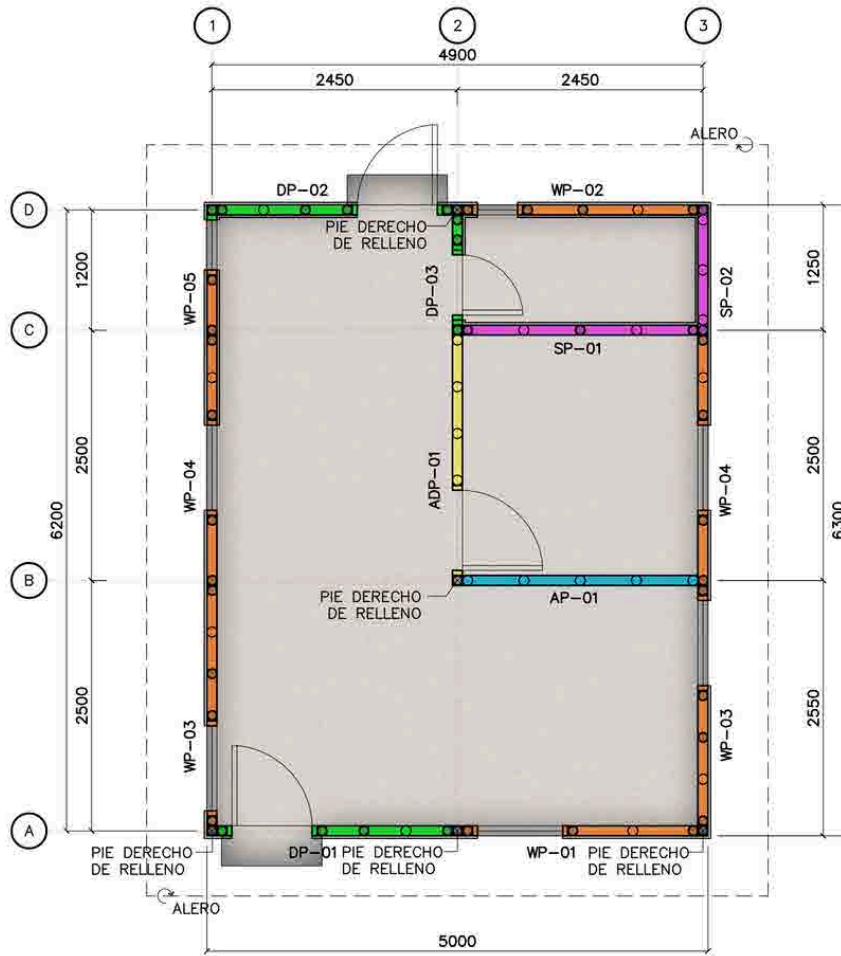
PLANO DE UBICACIÓN DE PANELES DE MURO
