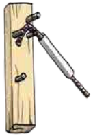
Dobladora de Varillas
