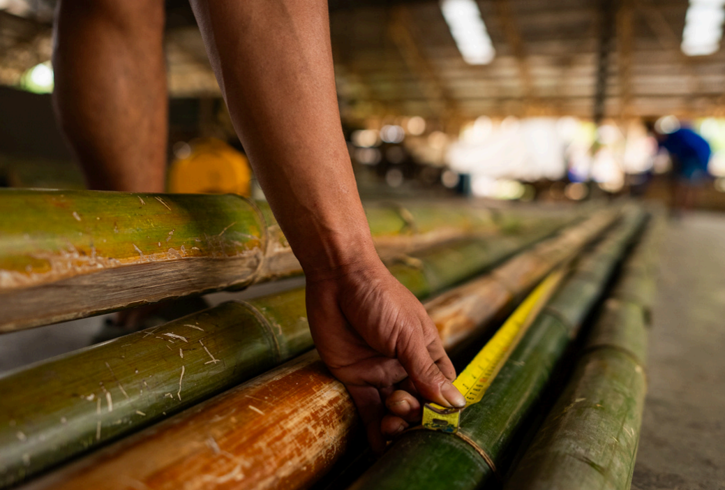
Un trabajador de Kawayan Collective en Dauin, Filipinas, realizando control de calidad de los culmos de bambú antes de utilizarlos en la construcción.
