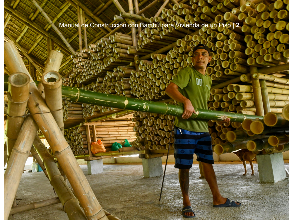
Perforación de nudos, parte del proceso de tratamiento del bambú
