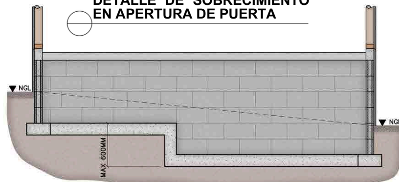
CIMENTACIÓN EN TERRENO INCLINADO (OUDSIÒN 1)
